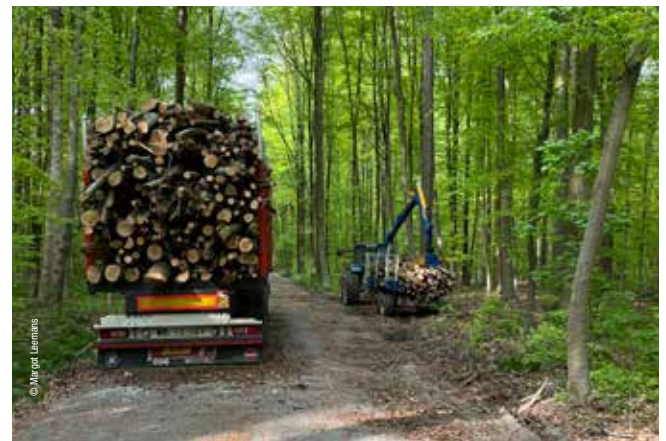
Bosweg met een geladen vrachtwagen met banden geschikt voor wegverkeer (links) en tractor met uitrijwagen (rechts).
