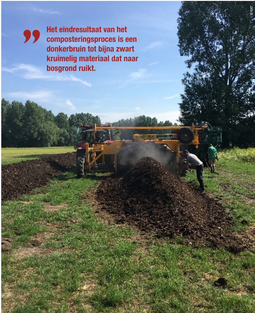
Figuur 4 Boerderijcompostering: de omzetmachine keert de compost (Bron: ILVO)
